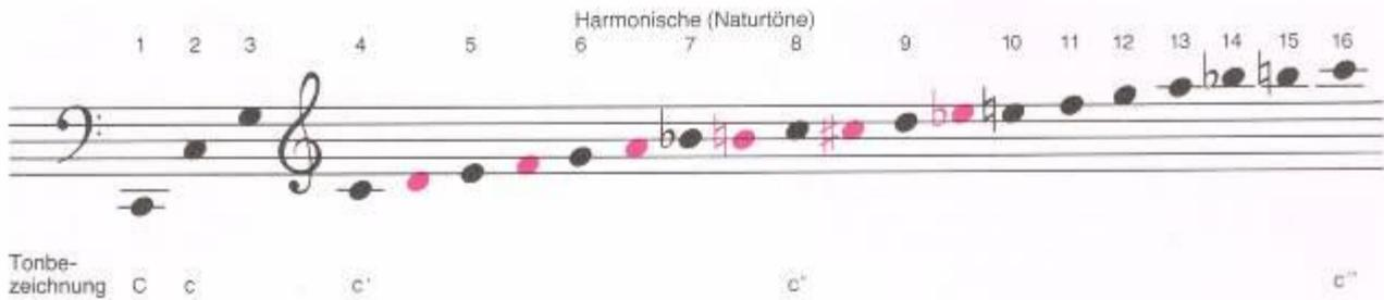
Bild 4: Die Folge harmonischer Partials (über dem Ton C (zwei Oktaven unter dem eingestrichenen oder mittleren c des Klaviers) entspricht den Naturtönen, die auf einer acht Fuß (rund 240 Zentimeter) langen Barock-Trompete spielbar sind. Einige der Töne, die häufig in der
